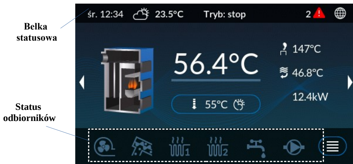
Ilustracja 11: Ekran główny, ekran kotła C.O.
