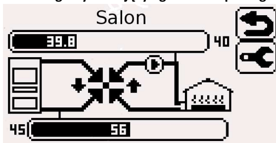
f) zawór czterodrogowy zasilający ogrzewanie grzejnikowe lub cały węzeł cieplny
